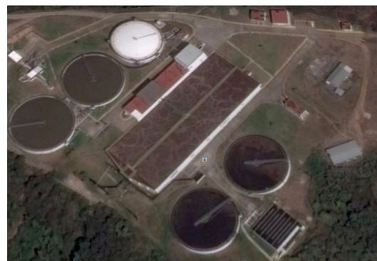
Distribución de una PTAR con un sistema de tratamiento CAS y digestión anaerobia de lodos primarios y secundarios.
